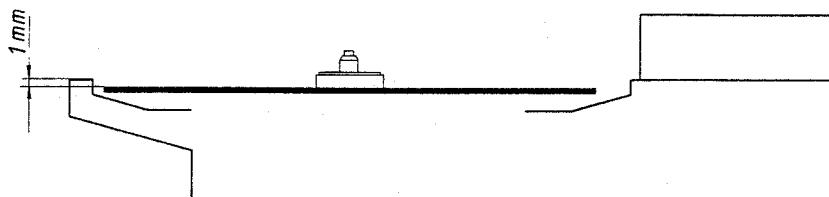
Værk højden justeres med skruerne B indtil overkanten af pladetallerkenen er 1 mm under overkanten af chassiset hele vejen rundt.
