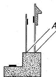
De tre mikroswitcher på løbeværkets bagkant kan justeres til sikkert skift, ved ilægning og udtagning af en kassette, ved at bukke switchene forsigtigt i punkterne A.
