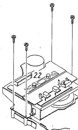
Toppladen for pladespilleren afmonteres og radio-delen anbringes i servicestilling.
