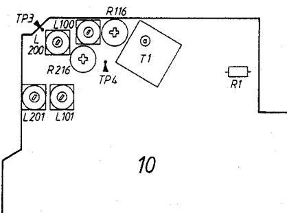
10R116 (10R216) justeres til der måles 12 mV i 9TP3 (9TP4) med LF voltmeter.
